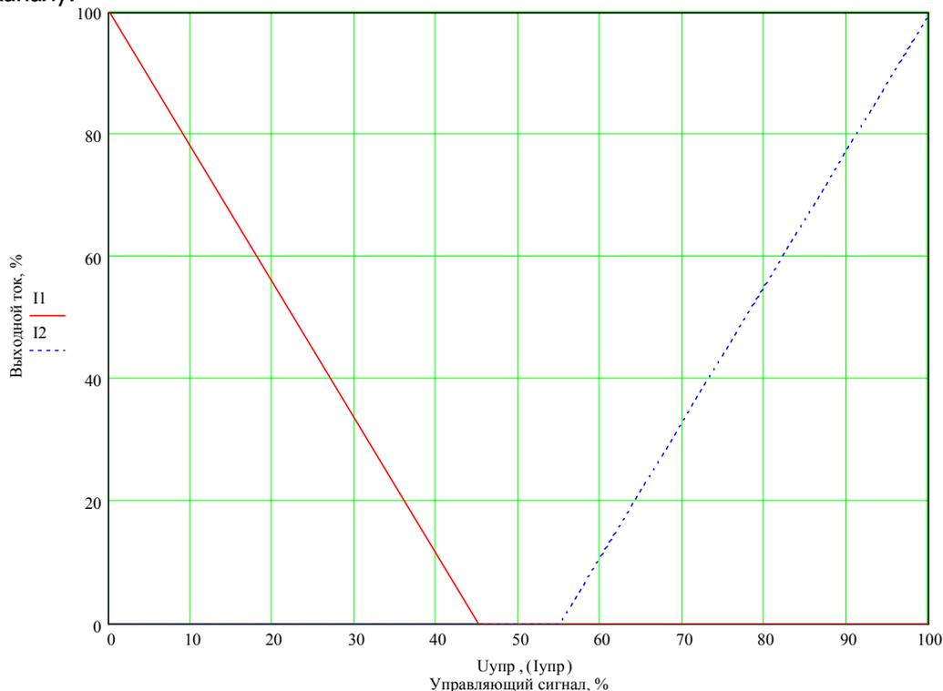
Диапазон выходного ШИМ сигнала и его частота также выбирается при настройке усилителя. Настройка производится для двух каналов сразу.
