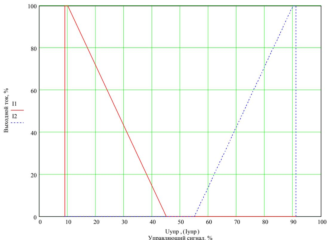
Для исключения эффекта «дребезга контактов» при граничных значениях управляющего сигнала запас по отключению тока ШИМ равен 0,1В или 0,04А.
