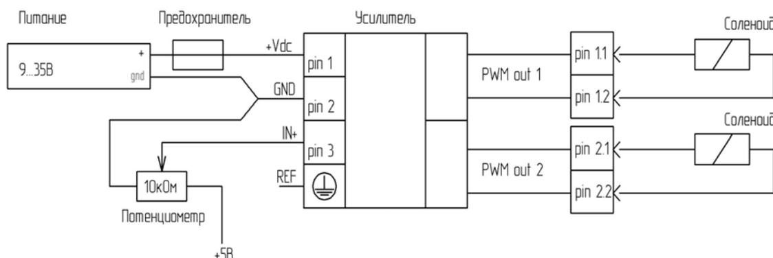
Использование потенциометра с встроенным источником опорного напряжения
